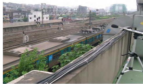
철도 소음 · 진동 측정
