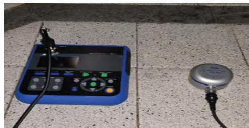
진동 픽업 지표 설치
